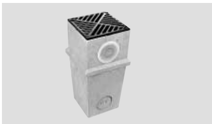
Bodová vpust pro napojení střešního svodu, rošt litina s jímek. nádobou z plastu, s předtvar. pro nátrubky DN 100, s vyjímatelným uzávěrem pachů, s předtvar. DN 100 pro napojení střešního svodu
